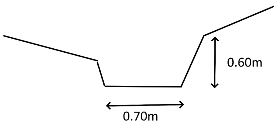
Figure 26 : coupe de principe du cours d'eau au niveau du point de confluence avec les différents écoulements – point 3
